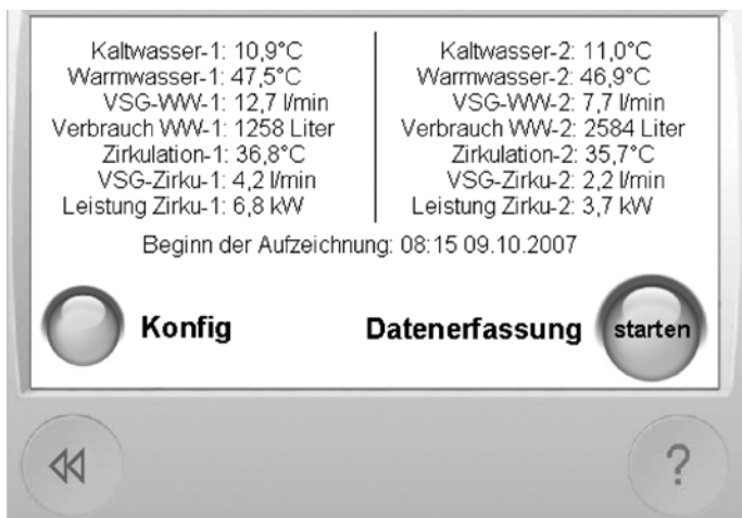
■ Solvis Prolog protokolliert den Warmwasser-Energieverbrauch bis zu einem Jahr lang. Bild: Solvis
